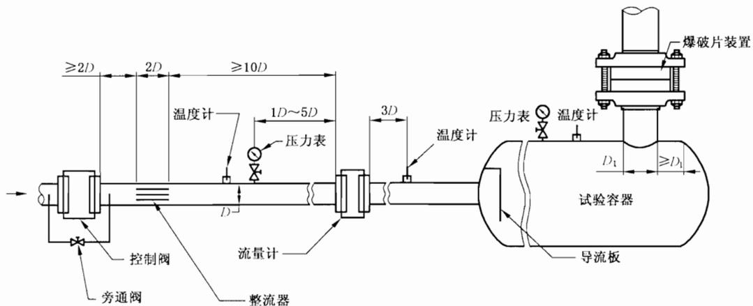
图 3 泄放量试验装置示意图
